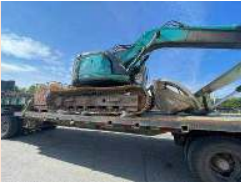
Рисунок 5.3 — Пример доставки автотранспорт на трале
